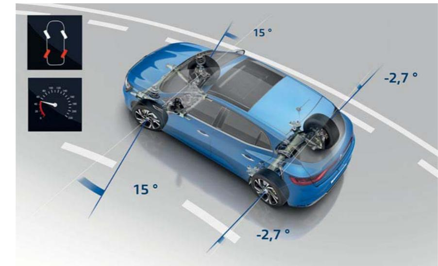
Bei tiefer Geschwindigkeit lenkt das System 4CONTROL die Hinterräder in entgegengesetzter Richtung zu den Vorderrädern.
