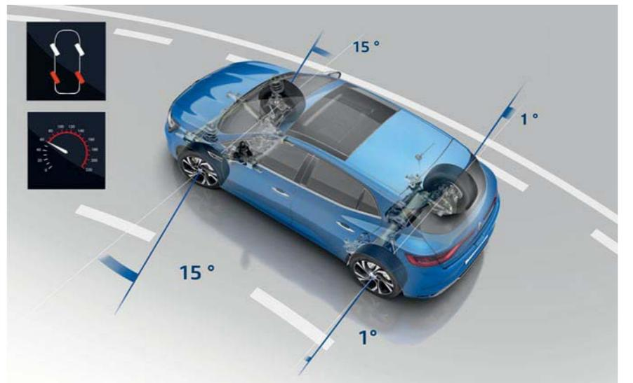
Bei über 80 km/h\* weisen die Hinterräder die gleiche Richtung wie die Vorderräder auf.
